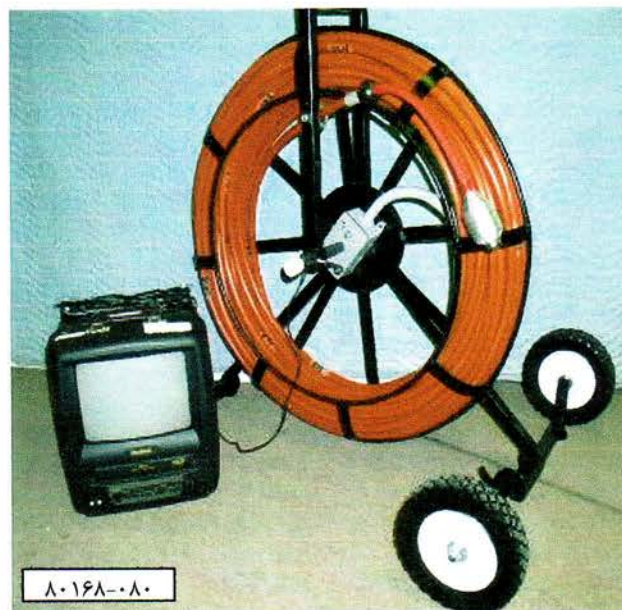
شکل ۷-۴: تجهیزات دوربین برای بازرسی شبکه
